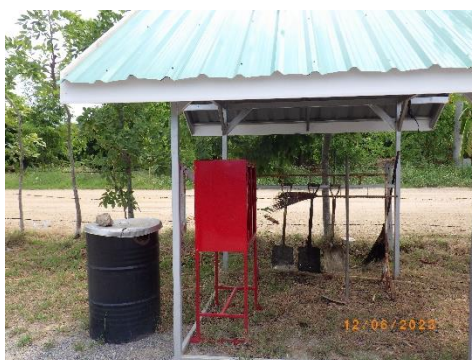
รูปที่ 2-12 ชุดอุปกรณ์ทำความสะอาดคราบน้ำมันที่จัดเตรียมไว้บริเวณหลุมผลิต
